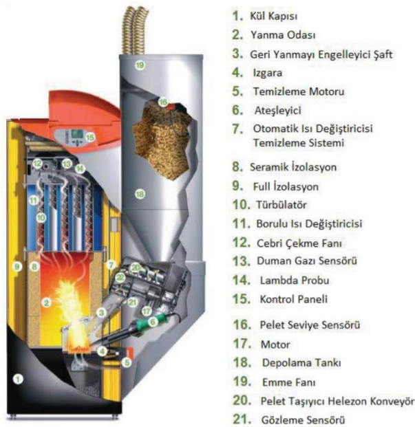
Şekil 3: Bir Pelet Kazanının Yapısı
